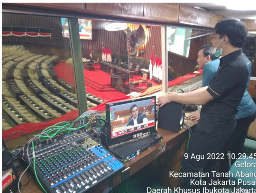
Studio di Ruang Rapat Paripurna I, Gedung Nusantara, DPR RI, Senayan, Jakarta. Penggunaan untuk pusat kendali operasi siang dari ruang sidang, mencakup peralatan switcher dan kendali kru yang di lapangan
